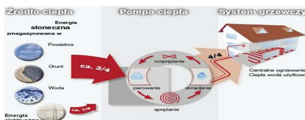
Rysunek 5. Schemat działania pompy ciepła (www.alpha-innotec.pl)
