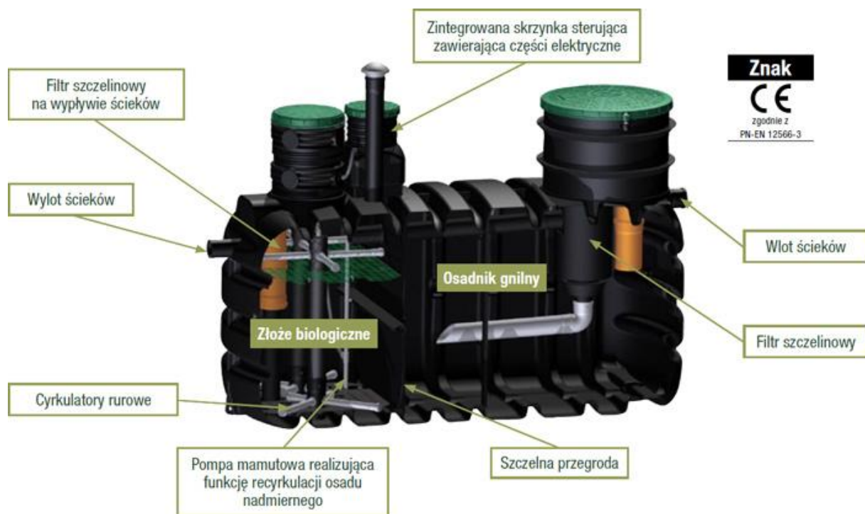
Rysunek 23. Schemat oczyszczalni hybrydowej typu BIO UNO
